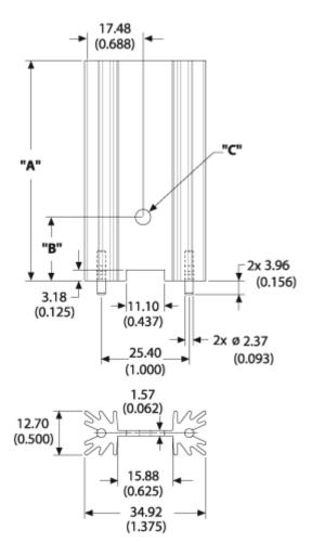
A Dim **38.10** B Dim **18.29** C Dim **3.18**
